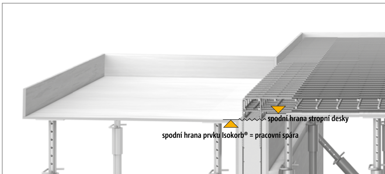
Obr. 41: Schöck Isokorb® typ K: Příprava bednění a výztuže před betonáží; úroveň pracovní spáry - stěna = úroveň bednění - spodní hrana balkónové desky!
