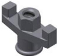
Die Flügelmutter kann bei verschiedenen Unterlagsplatten sowohl für Holz- als auch Stahlgurtungen als Anker Mutter verwendet werden. Sie ist so konstruiert, dass sie sowohl mittels Sechskantschlüssel als auch mit einem Gewindestab fixiert bzw. gelöst werden kann. Gegebenenfalls kann eine Klemmwirkung durch Hammerschlag auf die Flügel erzielt bzw. überwunden werden.
