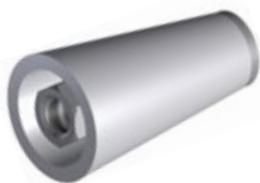
Der Kunststoffkonus mit Stahlkern ist eine Variante zu den Stahlkonen. Sein Anwendungsgebiet und seine Tragfähigkeit sind identisch. Durch die größere Konusneigung und den Kunststoffmantel lässt sich dieser leichter ausschalen. Außerdem kann das zurückbleibende Loch mit dem passenden Betonstopfen wesentlich leichter und besser verklebt werden.
