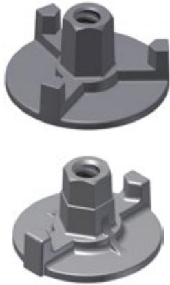
Die in fünf verschiedenen Durchmessern erhältliche Teller Mutter unterscheidet sich von der Flügel Mutter durch eine vergrößerte Aufstandsscheibe. Dadurch ist eine direkte Auflagerung auf den Gurtungen möglich. Diese können mit einem Sechskantschlüssel, einem Gewindestab oder einem Hammer angeschraubt bzw. gelöst werden.
