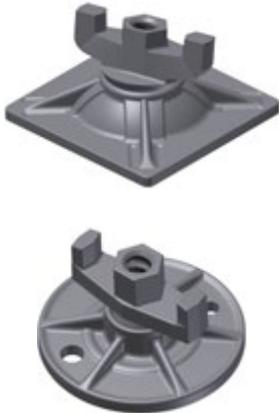
Bei der Kalottenplatte ist die Flügel Mutter wie bei der Kombiplatte unverlierbar mit der Platte verbunden. Hier sind allerdings sowohl die Platte als auch die Mutter aus Guss. Die Beweglichkeit der Flügel Mutter beträgt bei der quadratische Platte ca. 15° und bei der runden ca. 5%.
