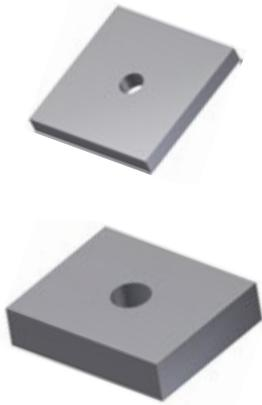
In Verbindung mit einer Flügel- oder Sechskantmutter zur Lastabtragung wird die Vollplatte bei Holz- oder bei Stahlgurtungen verwendet. Die Belastbarkeit richtet sich nach der Aufstandsfläche, der zulässigen Flächenpressung und dem verwendeten Gewindestab.
