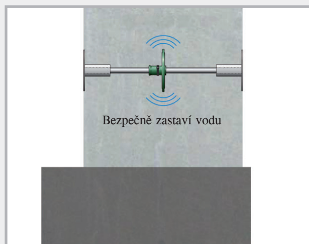
Stěnová průchodka „Safe“, připravena k instalaci
